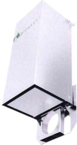
Das Wasser steigt von unten in die Haube, so dass der Schwimmer Auftrieb bekommt und sich vertikal nach oben bewegt. Die mit dem Schwimmer fest verbundene Steuerkurve bewegt die Schieberplatte über die Mechanik soweit vor die Drosselöffnung, dass die eingestellte Sollabflussmenge eingehalten wird.
