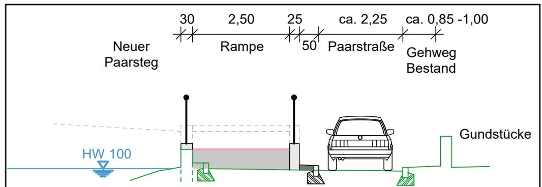
Oben: Rampe mit Handlauf und Ruhepodesten für Rollstuhlfahrer und Rollstuhlfahrerinnen. Unten: Querschnitt der Rampe auf der Paarstraße mit Fahrzeug und Grenze zu Grundstücken.
