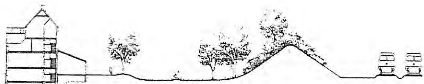
Zweistufiger Lärmschutz durch Wall und geschlossenen Bebauungsrand
